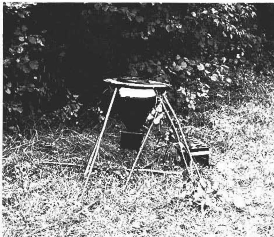
Fig. 1. Piège lumineux et système d'alimentation électrique.
